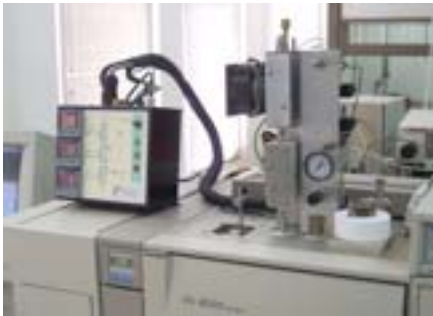
Thermal desorption unit
