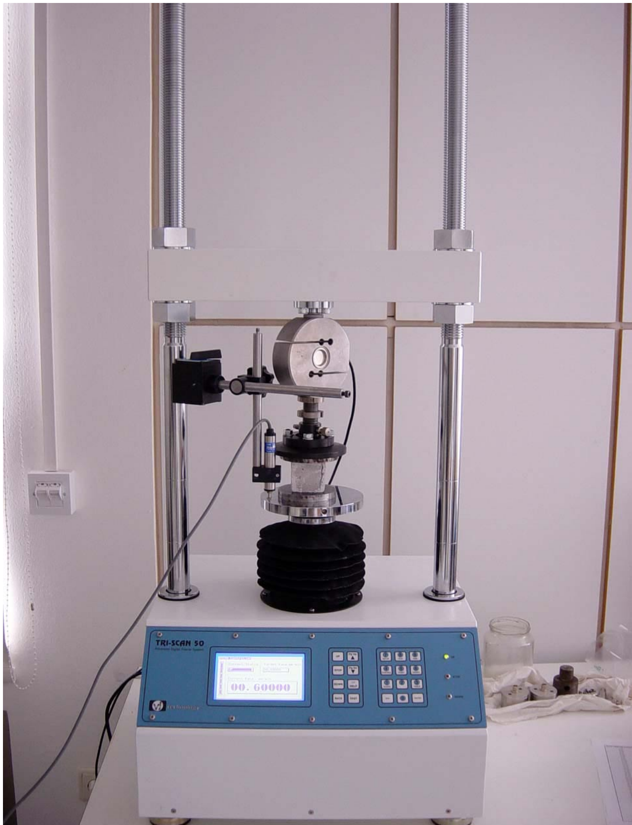
Συσκευή φόρτισης Triscan με δυνατότητα φόρτισης έως 50 kN.
