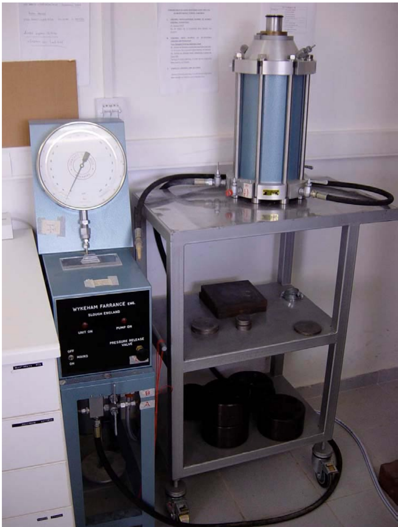
Συσκευή τριαξονικής φόρτισης δοκιμίων μέγιστης πλευρικής πίεσης 14 MPa του οίκου Wykeham Farrance.
