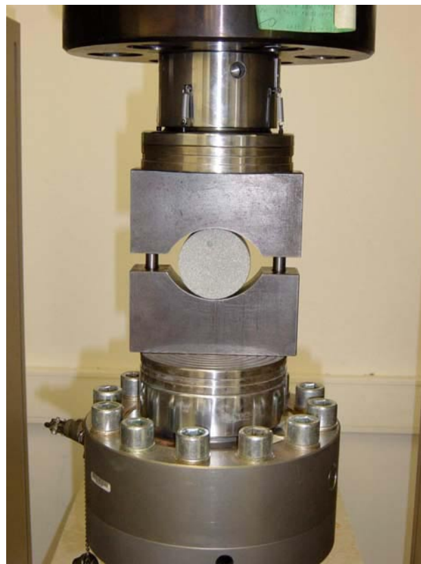
Δοκιμή έμμεσου εφελκυσμού (Brazilian test).
