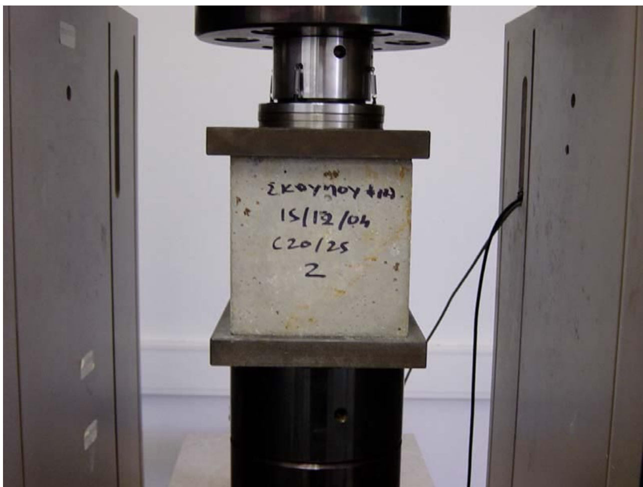
Δοκιμή μέτρησης αντοχής δοκιμίου σκυροδέματος.
