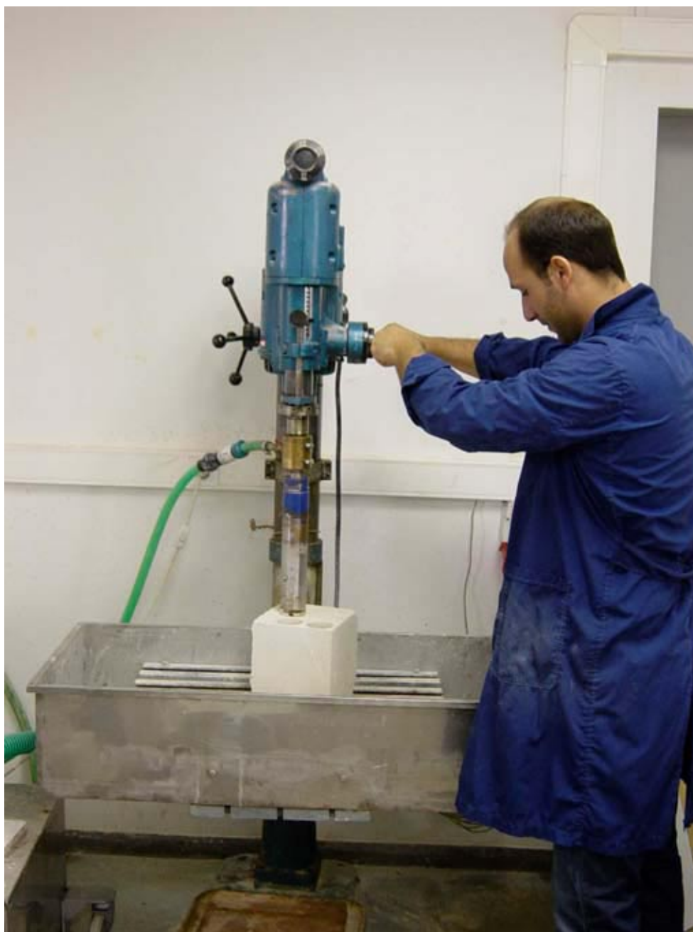
Διαδικασία πυρηνοληψίας κυλινδρικών δοκιμών από όγκο πετρώματος.
