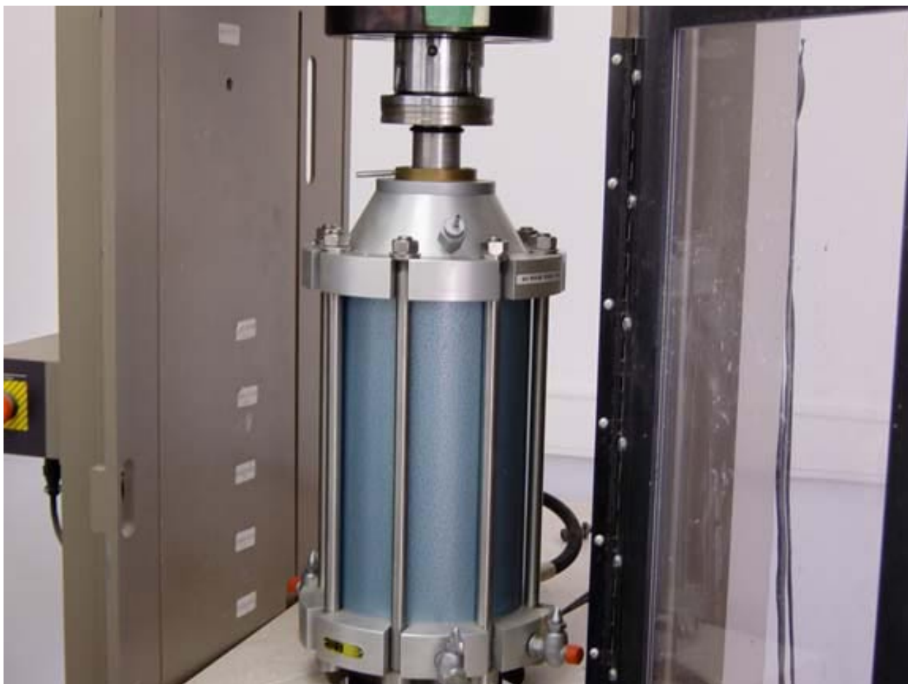
Δοκιμή τριαξονικής θλίψης με δυνατότητα πλευρικής πίεσης έως 14 MPa.
