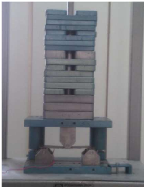
Εικόνα 33: Φορτισμένο δοκίμιο σε προχωρημένο στάδιο του πειράματος.
