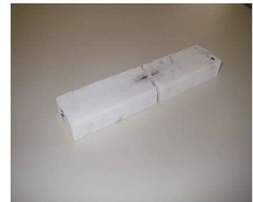
Εικόνα 40: Θραύση μαρμάρου Σκύρος 2.
